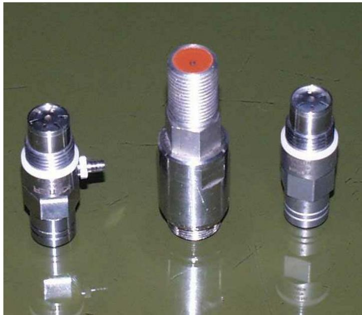
Figura 5. Transductor de presión dinámica, fotocélula y transductor de presión estática.
