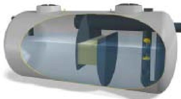
El depósito dispone de una capacidad de tratamiento de 30 m<sup>3</sup>/h, construido en PRFV. El separador contará con dos señales de alarma, una para la detección de nivel de sólidos y arenas y otra para la detección de nivel de aceites e hidrocarburos. El separador contará con un skimmer mecánico para la extracción automática de los aceites e hidrocarburos separados.
