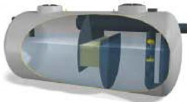
El depósito dispone de una capacidad de tratamiento de 10 m<sup>3</sup>/h, construido en PRFV. El separador contará con dos señales de alarma, una para la detección de nivel de sólidos y arenas y otra para la detección de nivel de aceites e hidrocarburos. El separador contará con un skimmer mecánico para la extracción automática de los aceites e hidrocarburos separados.
